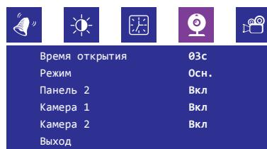
**Время открытия:** время срабатывания реле открытия замка.
