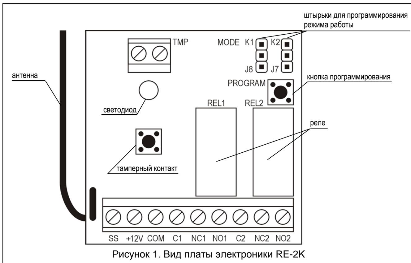
На плате электроники RE-1 находится только одно реле, и поэтому на плате нет штырьков K2 и клемм второго реле.
