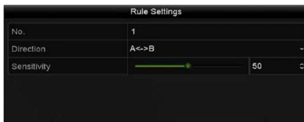
Рисунок 10-5 Установка правил обнаружения пересечения линии
