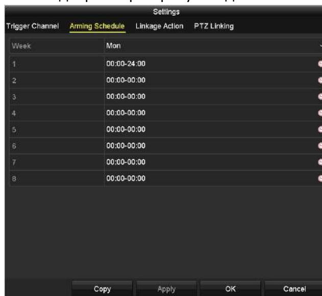
Рисунок 8-7 Установка расписания постановки на охрану тревожного входа
