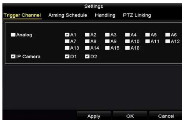
Рисунок 9-16 Установка срабатывающих каналов POS
