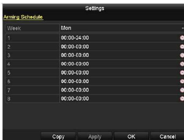
Рисунок 8-20 Установка расписания постановки на охрану тревожного выхода
