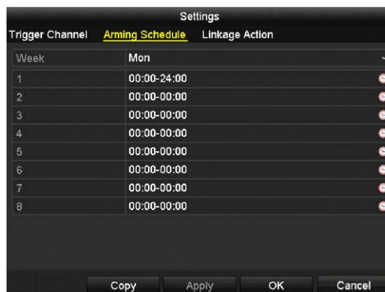
Рисунок 8-4 Установка расписания постановки на охрану обнаружения движения
