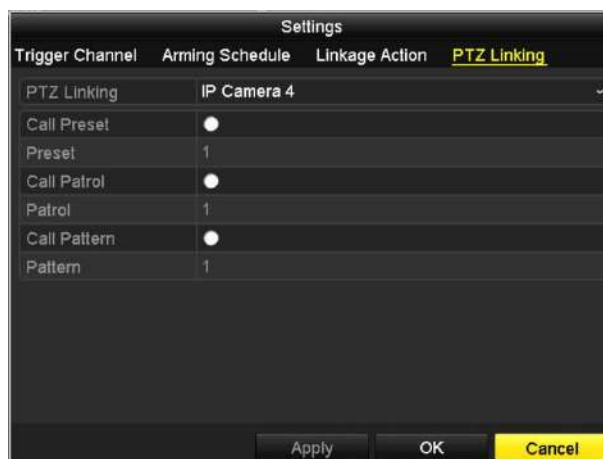
Рисунок 8.7 Установка привязки PTZ к тревожному входу
