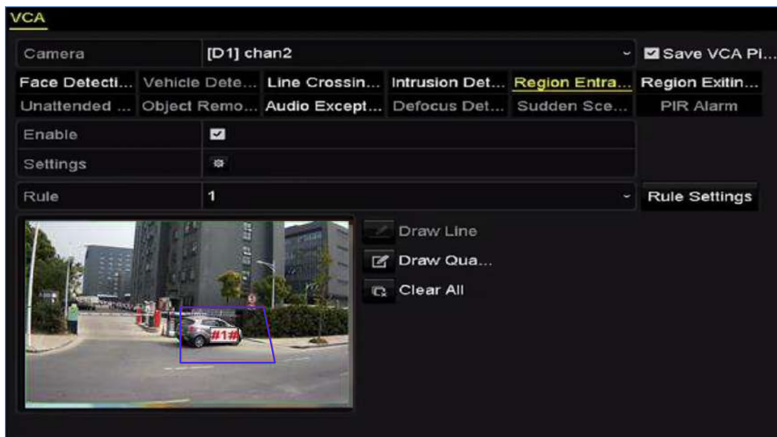
Рисунок 9.9 Установка области обнаружения входа в регион
