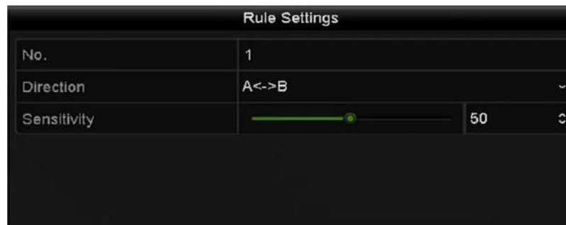
Рисунок 9.5 Установка правил обнаружения пересечения линии
