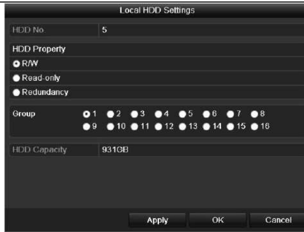
Рисунок 12.15 Установка свойств HDD
