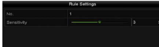
Рисунок 9.2 Установка чувствительности обнаружения лиц
