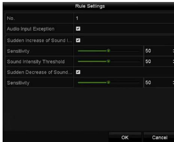
Рисунок 9.10 Настройка аудио исключений правила обнаружения
