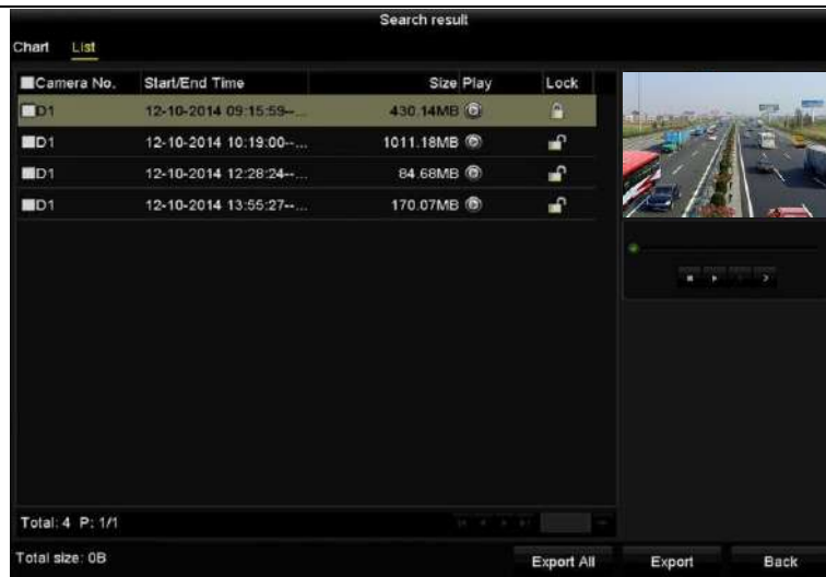
Рисунок 7.6 Результат нормального поиска видео для резервного копирования
