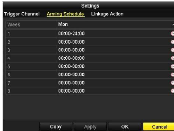
Рисунок 8.3 Установка расписания постановки на охрану обнаружения движения
