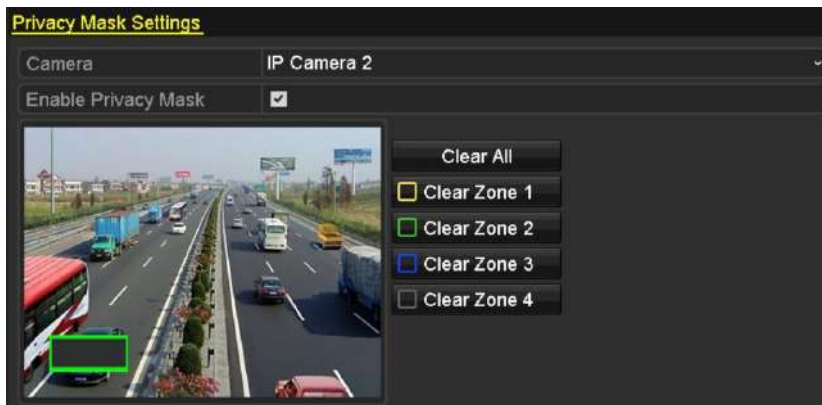
Рисунок 13.3 Установка области маскирования
