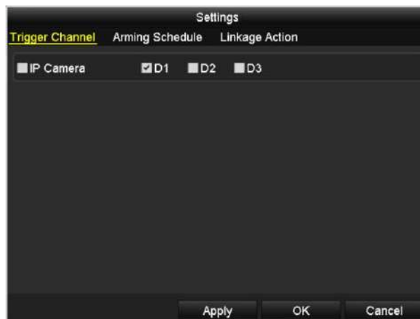
Рисунок 8.2 Установка срабатывающего канала по тревоге обнаружения движения
