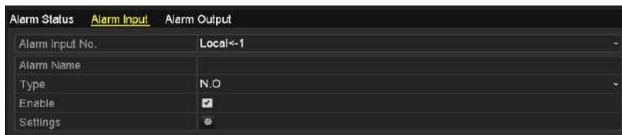
Рисунок 5.14 Настройки тревог – Тревожный вход
