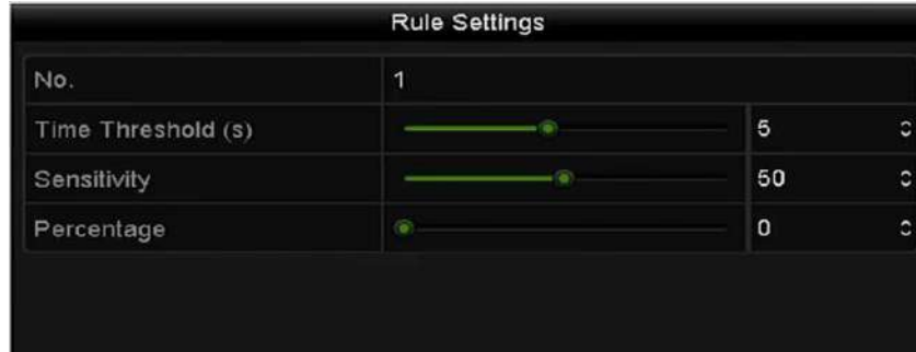
Рисунок 9.7 Установка правил обнаружения вторжения
