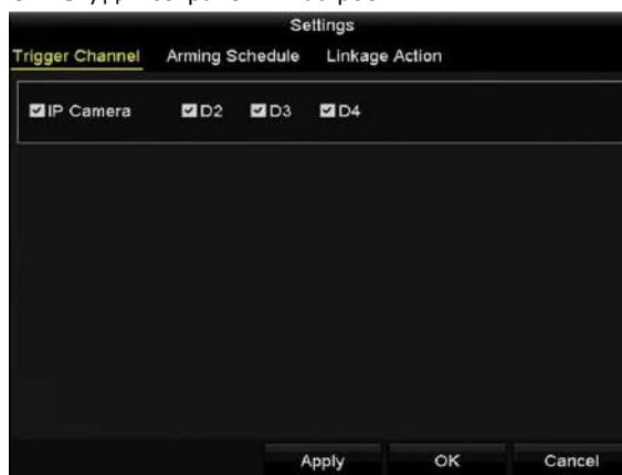
Рисунок 5.18 Установка срабатывающих каналов для VCA тревоги
