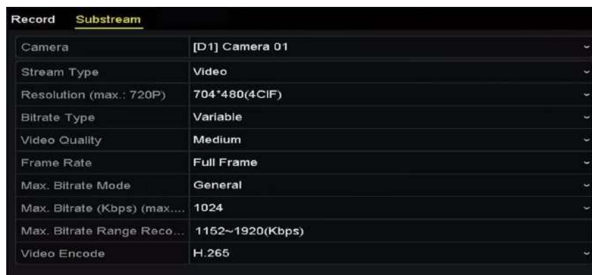
Рисунок 5.5 Кодирование дополнительного потока
